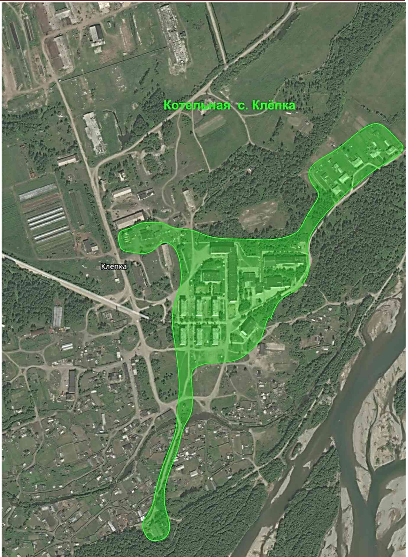
Рисунок 14 Зона действия системы теплоснабжения с. Клѣпка
