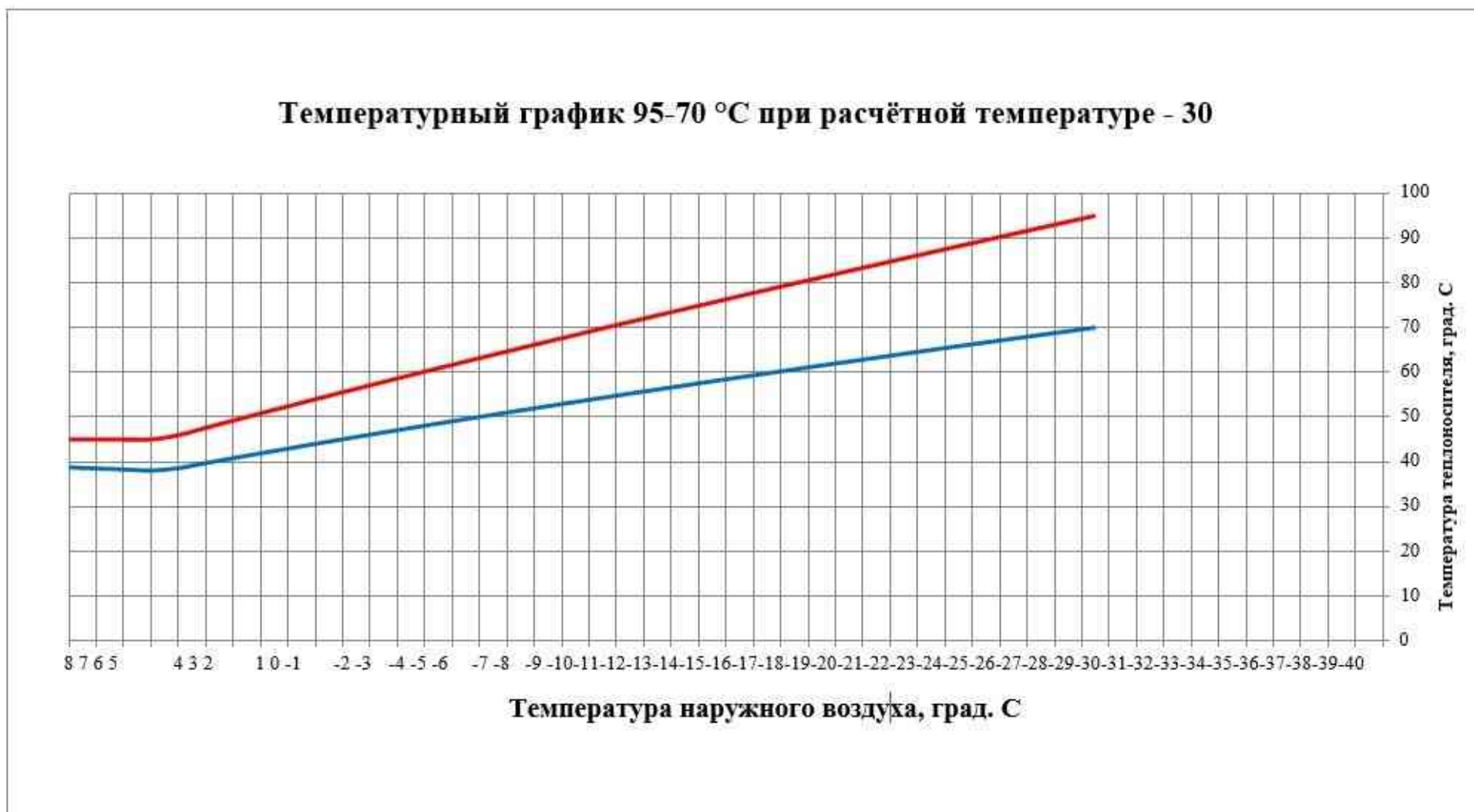
Рисунок 17 Температурный график 95-70 °С при расчётной температуре -30
