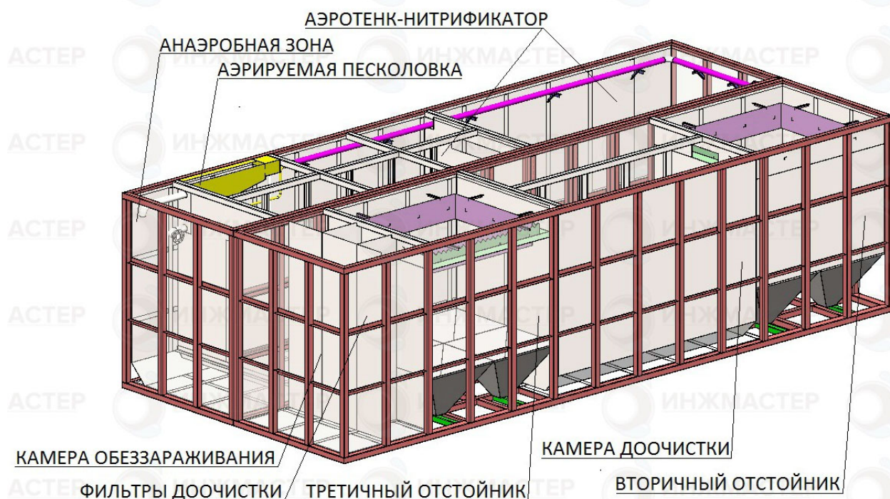
Рисунок 4.2 – Строение блочных очистных сооружений.
